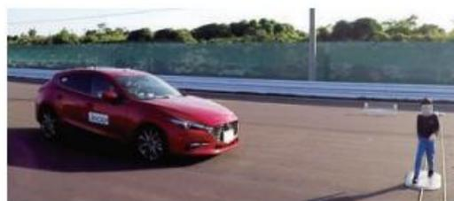
※正式名称：衝突被害軽減制動制御装置：Autonomous Emergency Braking System (AEBS)
