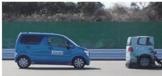
※正式名称：衝突被害軽減制動制御装置：Autonomous Emergency Braking System (AEBS)
